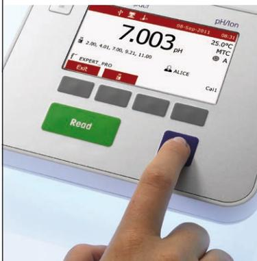
La asistencia para la calibración se proporciona en muchos niveles, incluidos grupos de tampones predefinidos y definidos por el usuario, un recordatorio de calibración con bloqueo opcional de sensores y un icono de sensor de pH, que muestra la calidad de la última calibración del electrodo.
