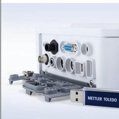
El sistema SevenCompact™ S213 permite el uso de sensores analógicos y digitales de pH y conductividad. Aproveche la completa selección de sensores de METTLER TOLEDO, tanto ahora como en el futuro.
