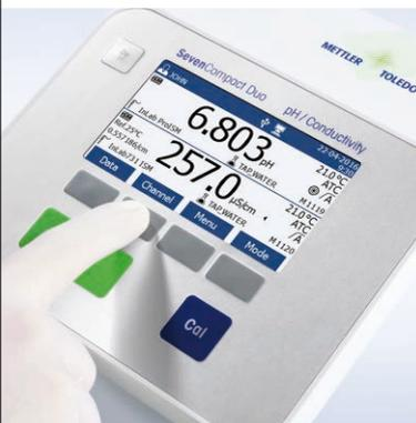
Tanto si mide el pH y la conductividad por separado como si lo hace de forma simultánea, el medidor cambia la visualización en pantalla solo con pulsar una tecla. En el diseño de pantalla normal, el medidor muestra toda la información disponible. Al cambiar a la vista uFocus™, la información se reduce a lo esencial.
