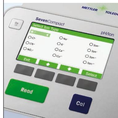
Los ocho tipos de iones usados con más frecuencia están preprogramados para que la configuración sea lo más cómoda posible. Para el resto, puede introducir iones genéricos con diferentes cargas iónicas para asegurarse de que la pendiente se calcula correctamente.
