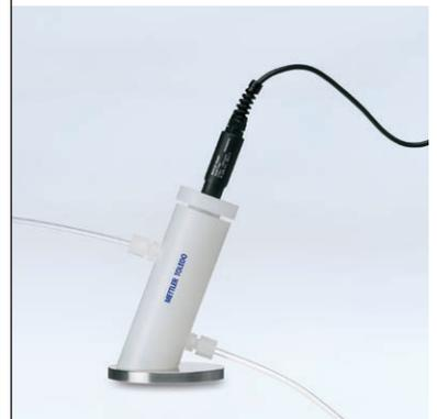
Mediciones de baja conductividad requieren especial atención. Al medir agua pura o ultrapura, hay varias fuentes potenciales de error, como el dióxido de carbono del aire y la imprecisión de la temperatura. La célula de conductividad digital InLab® Trace, con gran precisión de temperatura y célula de flujo opcional, ofrece la solución perfecta.
