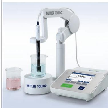
El agitador magnético opcional uMix™ de METTLER TOLEDO recibe alimentación y se controla desde el instrumento. El agitado se puede realizar tanto antes como durante la medición, y la velocidad de agitado se puede modificar en los ajustes del menú para adecuarse a la viscosidad de la muestra o al tamaño del recipiente de muestra.
